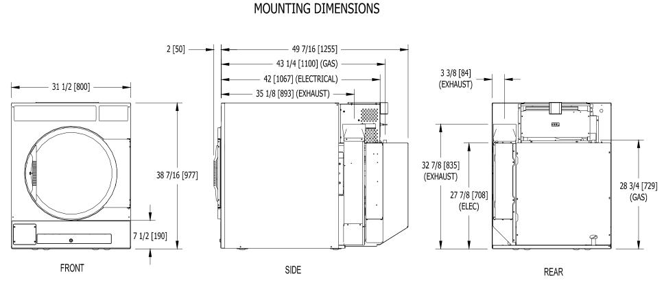
T-30SWD INDUSTRIAL STACK WASHER/DRYER (DRYER HALF)
