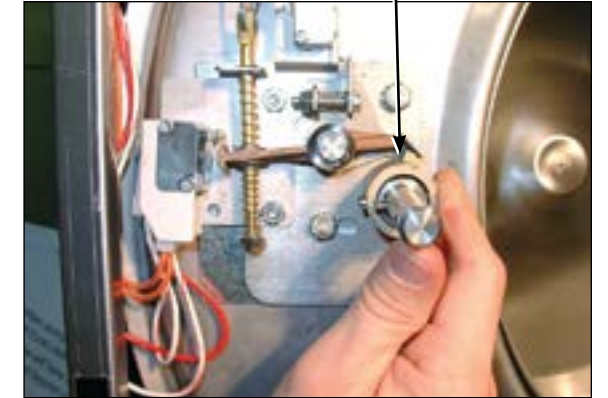
Door cam check position
