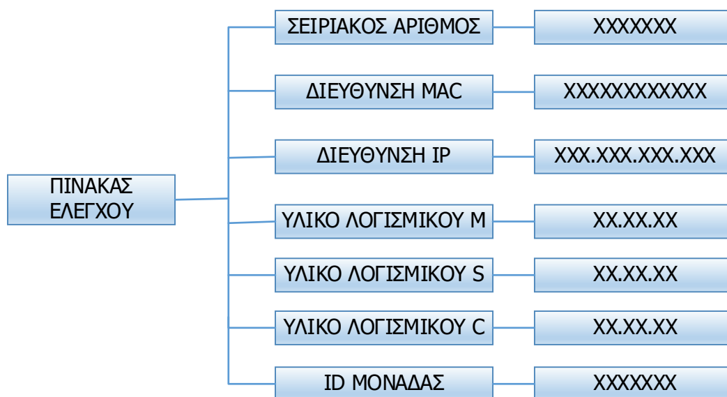
Εικόνα 7-14 Βασικό μενού πίνακα ελέγχου
