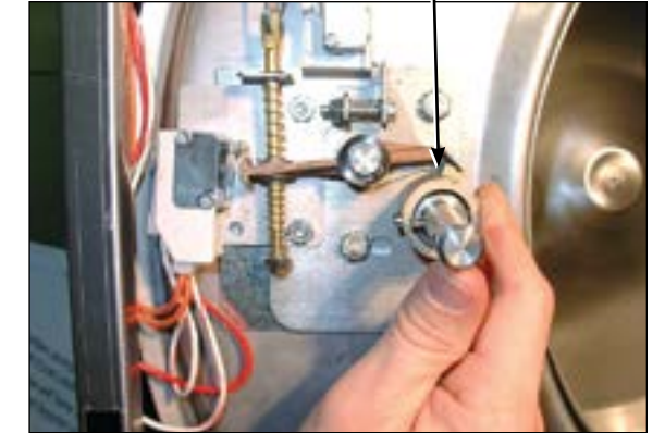
Door cam check position
