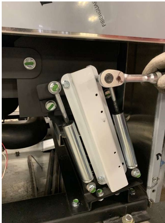
Εικόνα 7-5 Αφαίρεση προστατευτικών μεταφοράς
