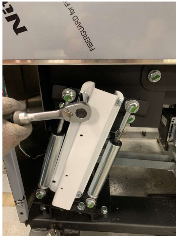
Εικόνα 7-6 Αφαίρεση προστατευτικών μεταφοράς
