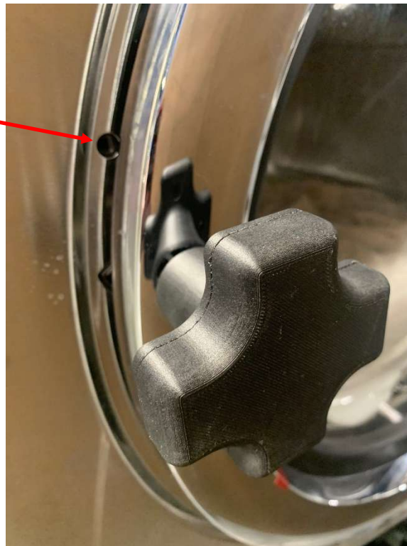
Εικόνα 7-20 Χειροκίνητη απασφάλιση πόρτας
