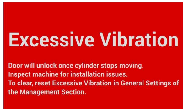
Figura 7-12 Errore di vibrazione eccessiva
