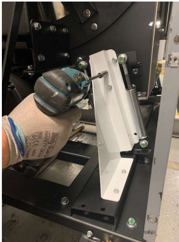
Εικόνα 7-2 Αφαίρεση προστατευτικών μεταφοράς
