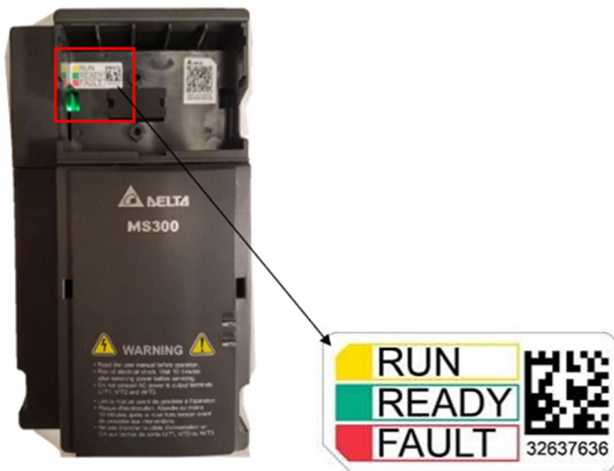
Εικόνα 7-21 Ενδείξεις LED μονάδας VFD
