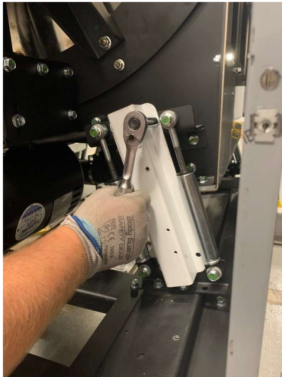
Εικόνα 7-3 Αφαίρεση προστατευτικών μεταφοράς
